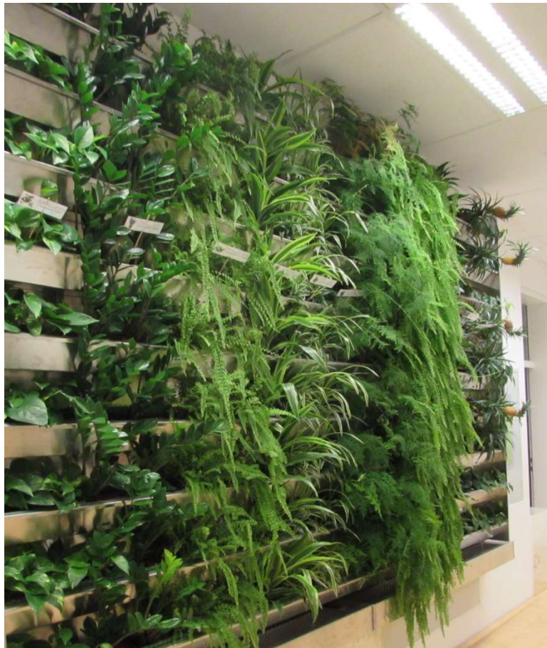
Abbildung 8: Trogsystem im Innenraum, lineare Pflanzenanordnung
